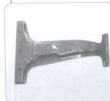
شکل 5- تقویت داخلی ستون B
