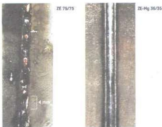
شکل ۴: اعمال لایه‌های ورق به کمک جوشکاری لیزری بدون درز و فاصله
