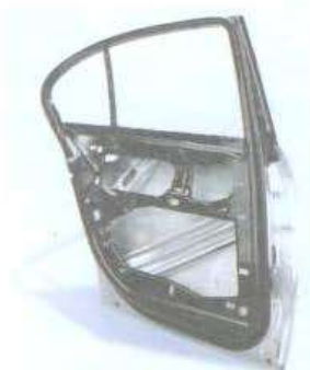
شکل ۳. نمونه اولیه درب‌های چند قسمتی
