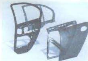
شکل ۳ قسمت‌های داخلی و خارج درب‌های چند قسمتی
